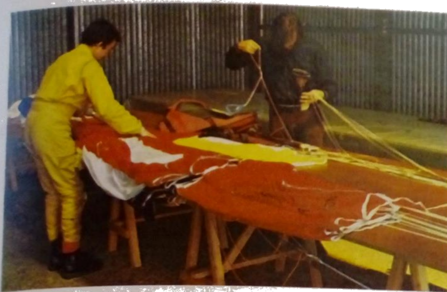
Είκ. 6. Έλεγχος καί συσκευασία του άλεξίπτωτου. Τ' άλεξίπτωτα πού δέν χρησιμοποιούνται κανονικά πρέπει νά βγούν από τή θήκη τους καί νά έλεγχθούν. Χρησιμοποιούνται καί χώροι, όπου διαμόρφώνονται οί συνθήκες, πού έπικρατούν στόν άέρα.
