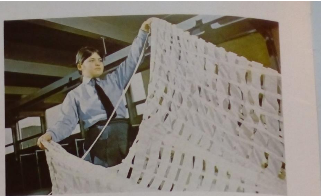
Είκ. 4. Κατασκευή άλεξίπτωτων. Κατασκευάζονται με διάφορους τρόπους ανάλογα με τή χρήση τους. Για τή ρίψη φορτίων βαριά άλεξίπτωτα διαμέτρων 30 m ή συνδυασμοί από άλεξίπτωτα. Για ύπερηχητικά άλεξίπτωτα πρέπει νά ληφθεϊ ύπόψη, ή ροή του άέρα καί τά κρουστικά κύματα. Άκόμη καί πριν από τό Β' Παγκόσμιο Πόλεμο ό σχεδιασμός τών άλεξίπτωτων είχε έξελιχθεϊ πολύ.
